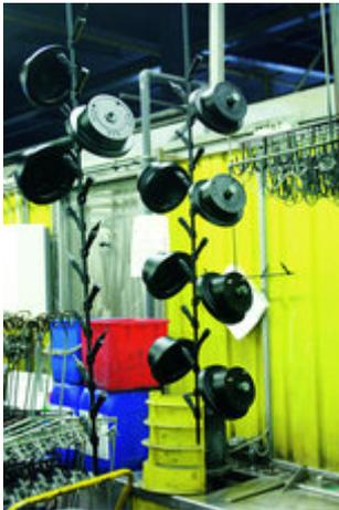
Durch den Einsatz der Längsträgergestelle wurde die Behängungsdichte um den Faktor 4 erhöht. Quelle: Redaktion
