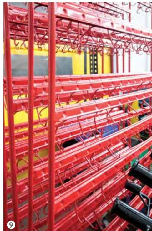
**Figura 9: Un adeguato sistema di appensione ottimizza le operazioni di verniciatura.**
