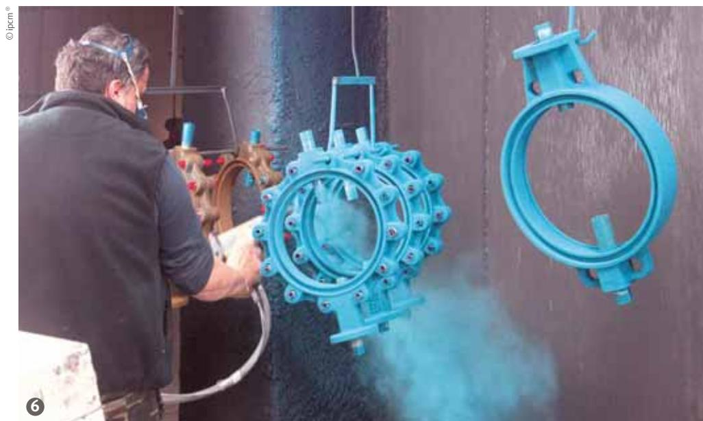
**Figura 6: Applicazione manuale della vernice.**
