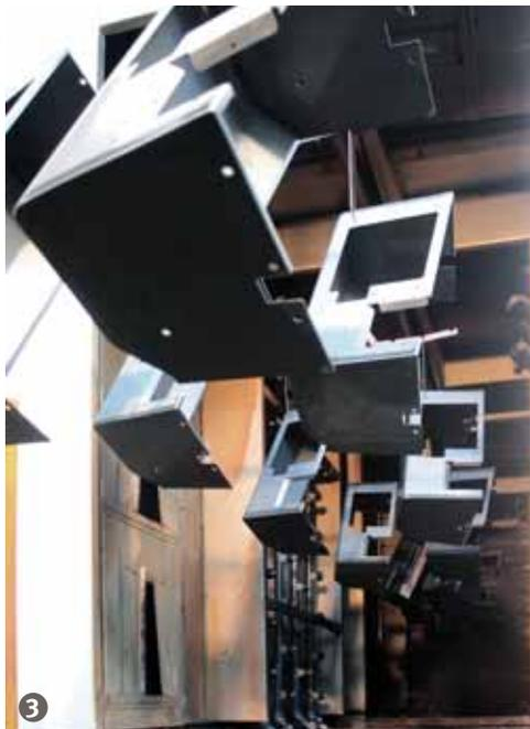
**Figura 3: Ingresso nel tunnel di pretrattamento.**
