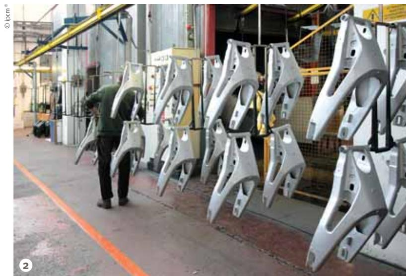
**Figura 2: Alcuni componenti del settore motomotive verniciati in Verniciatura Braglia.**
